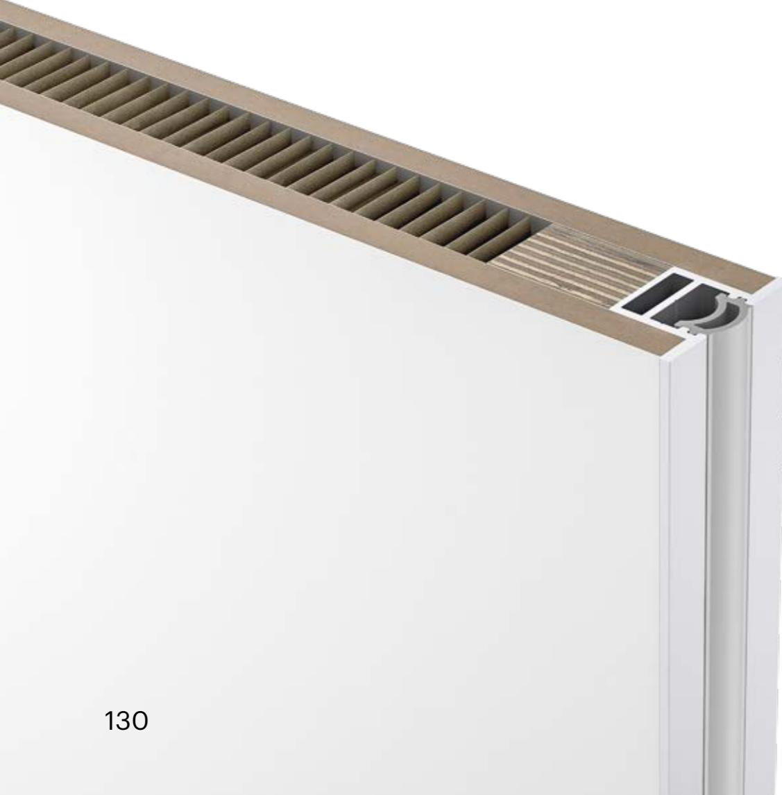
Rahmenprofilsystem mit integrierter Anschlagdichtung und 2,5 mm Profilansicht als Wabenleichtbaupaneel mit Einlassmuschel. Für Durchgangstüren, Raumteiler und begehbarer Schränke. Materialstärke 38 mm.
