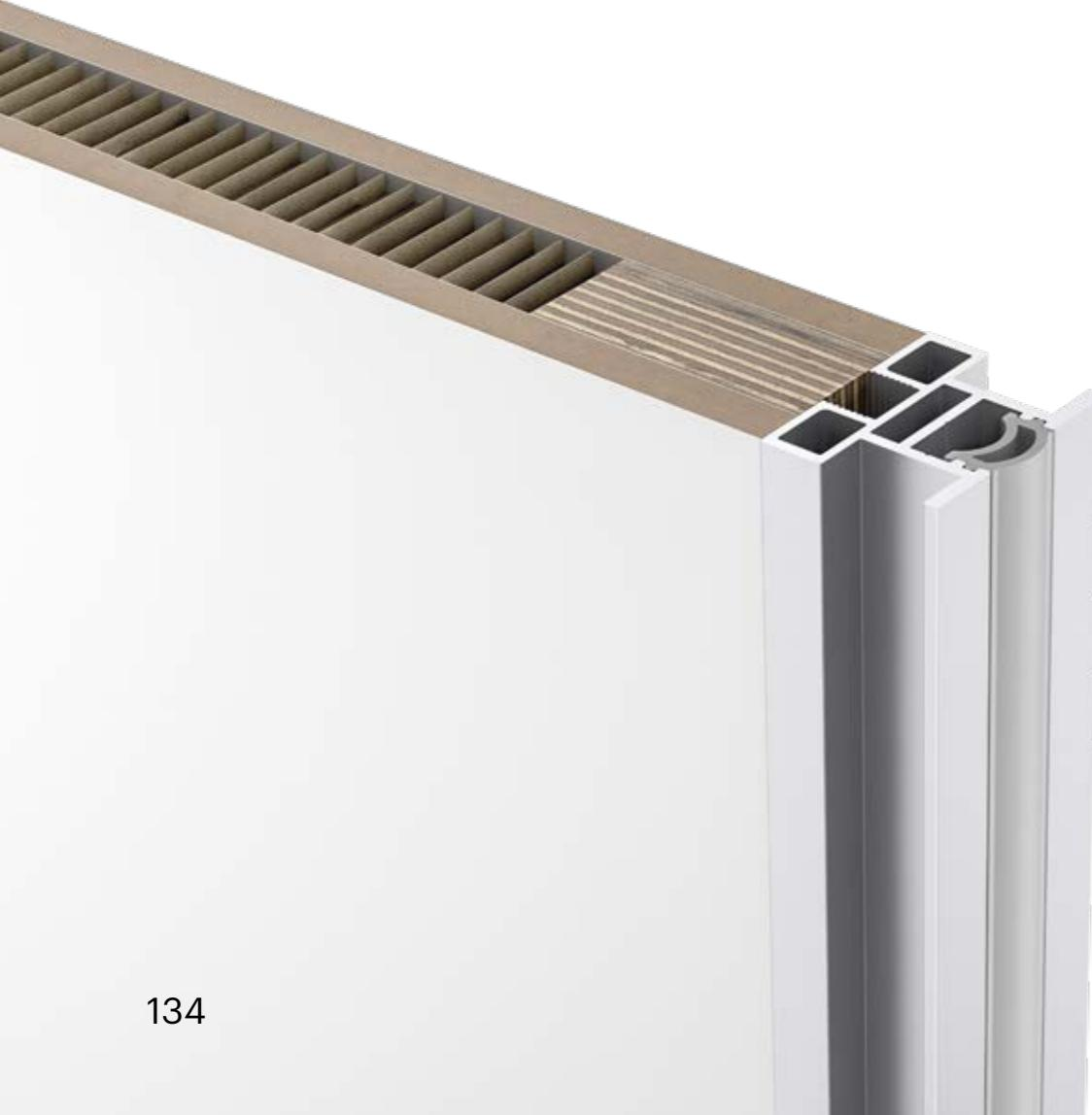
Rahmenprofilsystem mit vertikaler Griffleiste, integrierter Anschlagdichtung und 30 mm Profilansicht als Wabenleichtbaupaneel. Für Durchgangstüren, Raumteiler und begehbarer Schränke. Materialstärke: 38 mm.
