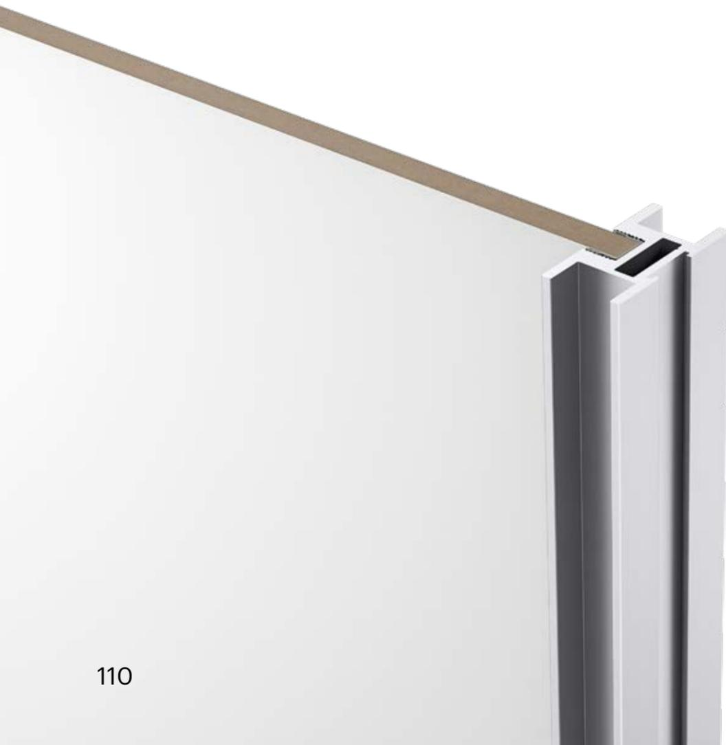
Rahmenprofilssystem mit vertikaler Griffleiste, integrierter Bürstendichtung und 20 mm Profilansicht. Für Schrankfronten und begehbare Schränke. Materialstärken: 4, 6, 8 und 10 mm
