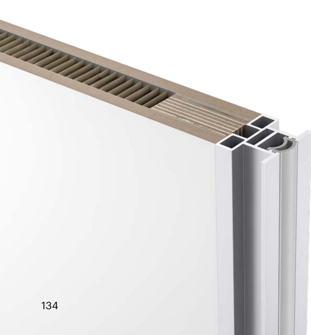
Rahmenprofilssystem mit vertikaler Griffleiste, integrierter Anschlagdichtung und 30 mm Profilansicht als Wabenleichtbaupaneel. Für Durchgangstüren, Raumteiler und begehbare Schränke. Materialstärke: 38 mm.
