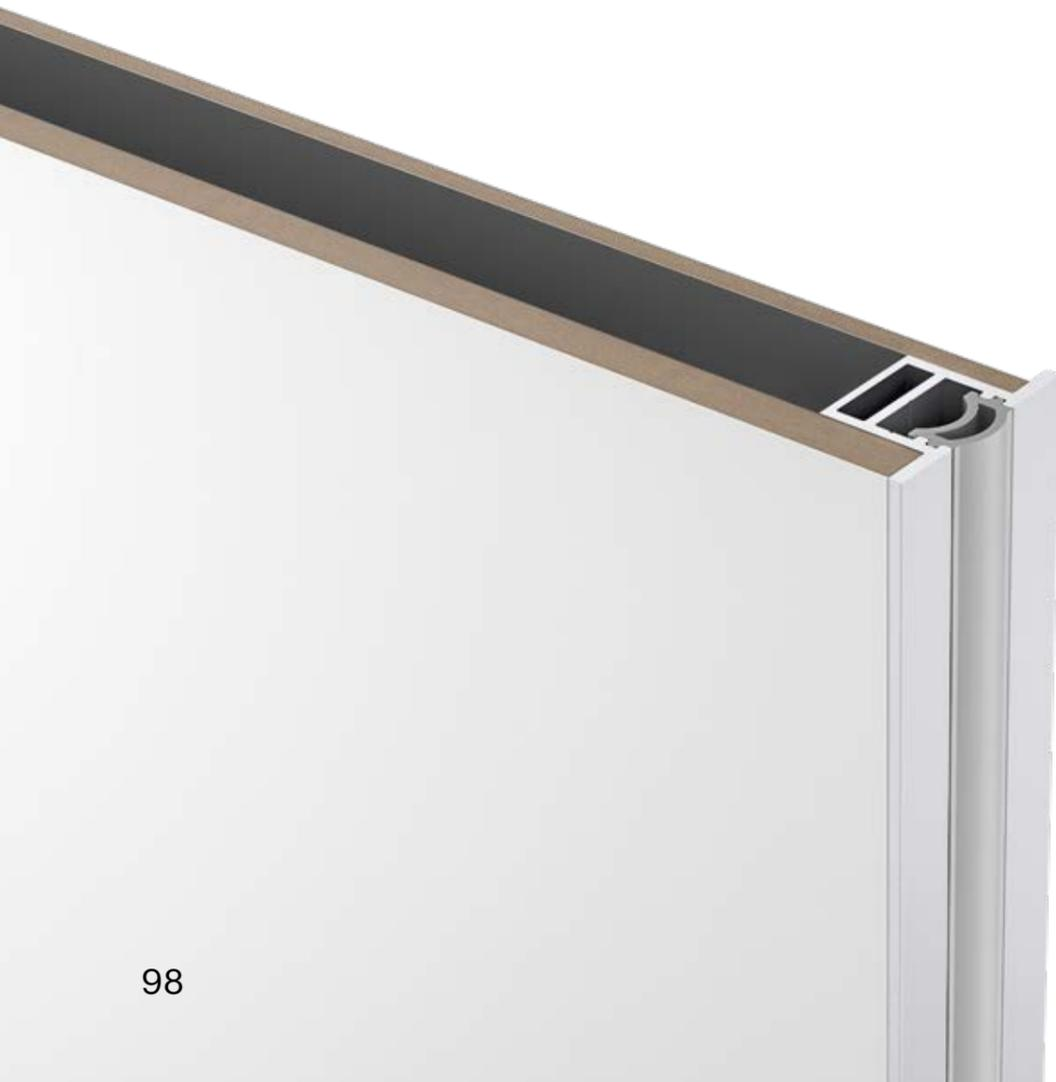
Rahmenprofilssystem, raumseitig flächenbündig und grifflos mit integrierter Anschlagdichtung und 2,5 mm Profilansicht. Für Schrankfronten und begehbare Schränke. Materialstärken: 4, 6, 8 und 10 mm.
