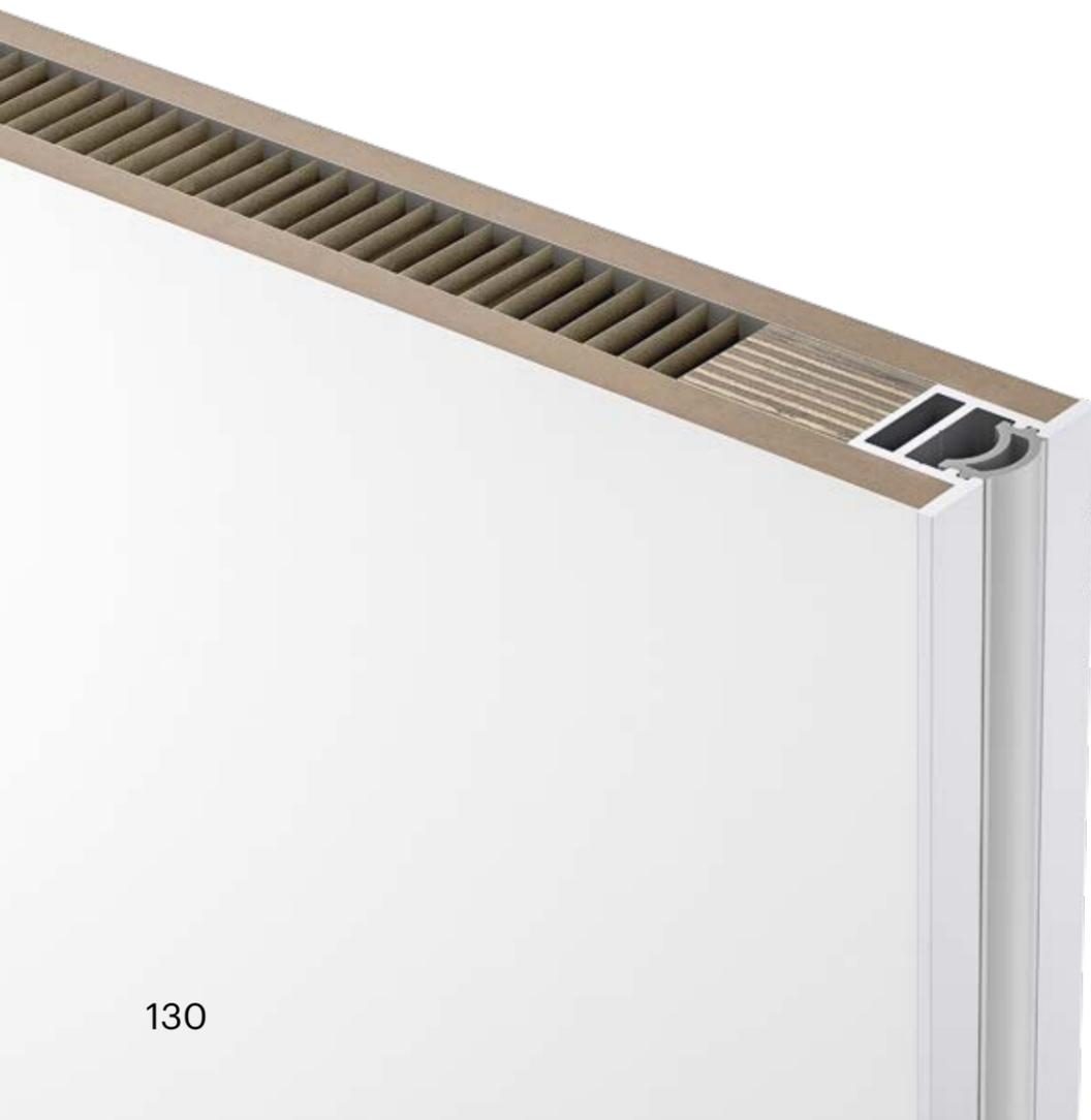
Rahmenprofilssystem mit integrierter Anschlagdichtung und 2,5 mm Profilansicht als Wabenleichtbaupaneel mit Einlassmuschel. Für Durchgangstüren, Raumteiler und begehbare Schränke. Materialstärke 38 mm.
