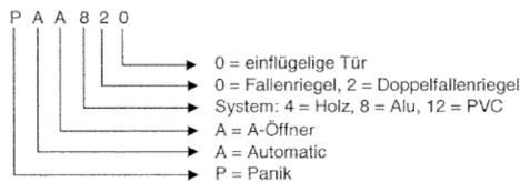
Die Schlosstypen PA 400 – 1220, GU-SECURITY Automatic-DRP und Security 1910 – 1919S können mit autarker Zusatzfalle am Langstulp in Kombination mit Fluchttüröffner EFF-EFF 332 als elektrisch verriegeltes Panikschloss (Security EVP) betrieben werden. Panikfunktion nur bei freigeschaltetem (spannungslos) Türöffner EFF-EFF 332 gewährleistet. (Dann nur VS-TYP B).
