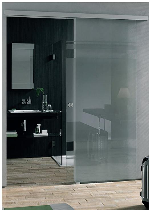
Portavant 60 permet un amortissement des deux côtés à rappel automatique sans entaille du verre avec une hauteur de profil de seulement 57.5 mm dès une largeur de vantail de 380 mm et jusqu'à un poids du vantail de 60 kg.
