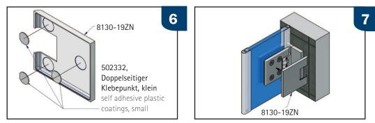
Die Abdeckkappen 8130-19ZN werden ebenfalls mit Klebepunkten Best.-Nr. 502332 am Duschtürband fixiert. Diese kleben Sie bitte vor dem Aufsetzen der Kappe 8130-19ZN in die dafür vorgesehenen Vertiefungen.
