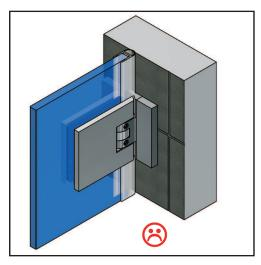
Um ein Kippen der Drehachse zu verhindern, sollte das Duschtürband immer vollflächig auf einer Fliese montiert werden!
