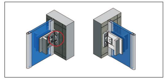
Zur Fixierung der Abdeckkappen 8134-2ZN liegen den Beschlägen doppelseitige Klebepunkte, Best.-Nr. 502332, bei. The fittings are provided with dself adhesive plastic coatings for fixing the 8134-2ZN cover plates, Art.-No. 502332.
