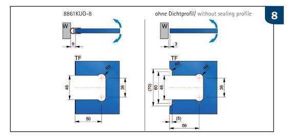
Je nach verwendetem Dichtprofil ist darauf zu achten, dass unterschiedliche Glasbearbeitungen zum Einsatz kommen. Achtung: alle Maße beziehen sich auf 8 mm Glas The glass processing differs with each kind of sealing profile. Caution: All measurements are valid for 8 mm glass thickness.
