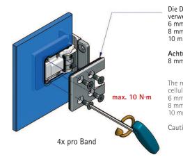
Die Dicke der Einlagen richtet sich nach der verwendeten Glasstärke: 6 mm Glas: 3 mm Einlagen 8 mm Glas: 2 mm Einlagen 10 mm Glas: 1 mm Einlagen
