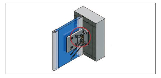
Wenn der Türflügel ausgerichtet ist und alle Dichtprofile aufgesteckt wurden, kann die Nulllage eingestellt werden. Dabei sind die Gewindestifte wechselweise auf das angegebene Drehmoment anzuziehen und nach ca. 15 Minuten nachzuziehen.
