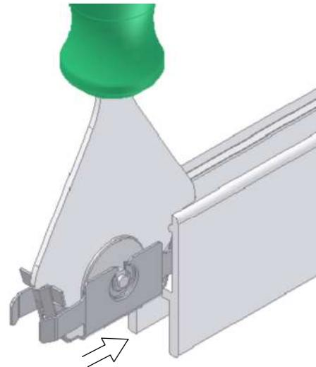
① Der Laufwerk-Setzer nimmt das Laufwerk an den Federbeinen auf.
