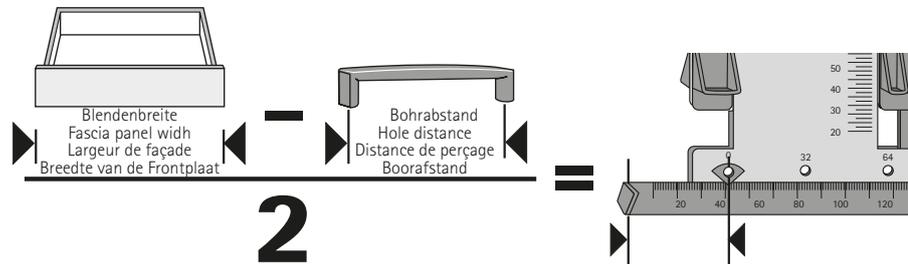
Abstand Blendenseitenkante bis zur ersten Befestigungsbohrung des Griffes
