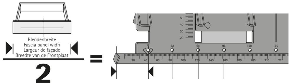
Abstand Blendenseitenkante bis zur Befestigungsbohrung des Knopfes
