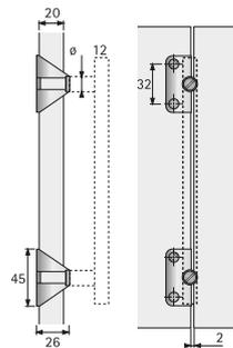
Einsetzbar für alle Grifflösungen bei einer maximalen Türdicke von 20 mm und einer Griff-Aufstandsfläche, mindestens  $\varnothing$  12 mm.
