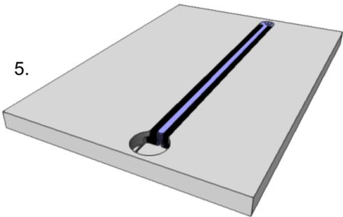
Abdeckprofil aus Kunststoff zwischen die beiden Profilschienen eindrücken bis es bündig ist.
