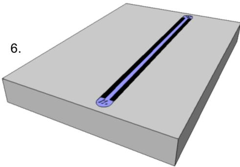
Abdeckprofil aus Kunststoff zwischen die beiden Profilschienen eindrücken bis es bündig ist.
