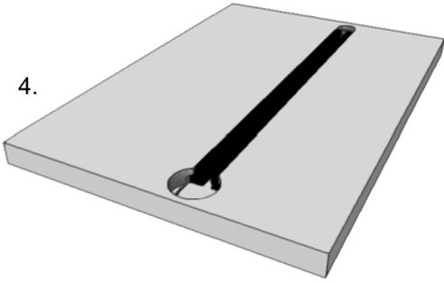
Profilschienen aus Stahl von Hand hineinlegen und an die linke und rechte Seite drücken.
