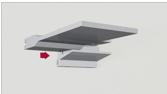
Steckprofil seitlich über das Basisprofil einschieben.
