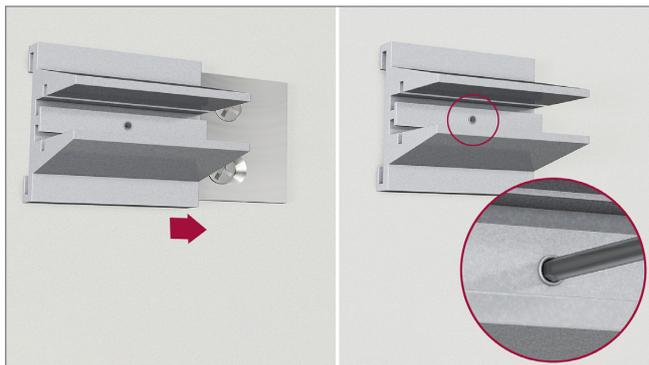
Basisplatte seitlich über die Grundplatte einschieben und die Madenschraube anziehen.
