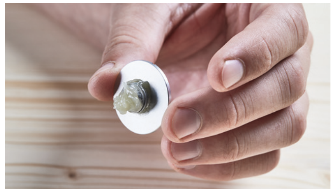
Avant tout contact avec la colle, enduire les assemblages vissables avec l'agent de séparation Collano HP 2000.
