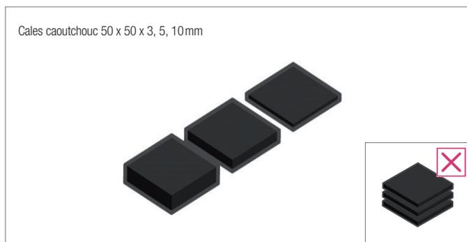
Des cales caoutchouc peuvent être utilisées pour mettre à niveau ou relever le soubassement et éviter ainsi l'humidité stagnante. Ne pas superposer des cales caoutchouc.
