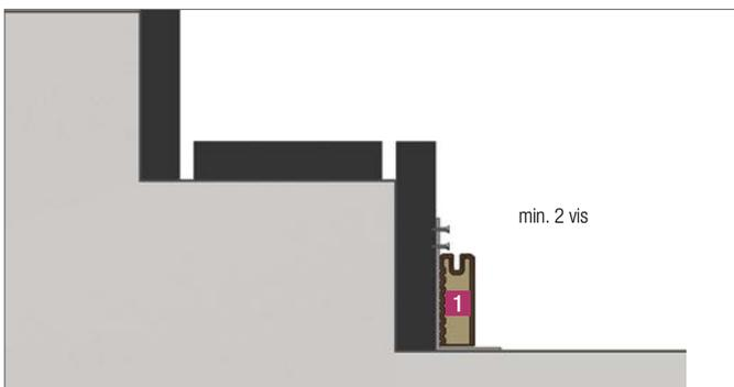
3. Fixation de l'équerre de fixation sur la lambourde
