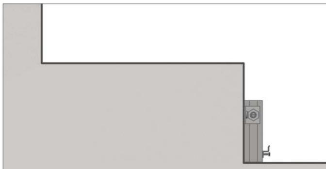
1. Mise en place de la lambourde et de l'agrafe d'extrémité
