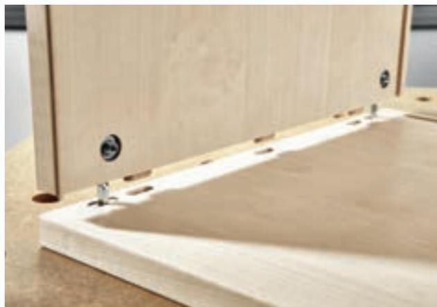
**Tutto come di consueto:** Le giunzioni vengono realizzate con la fresatrice per giunzioni DOMINO DF 500. La dima di foratura aspirabile indica la posizione esatta del foro nonché la corretta profondità di foratura.
