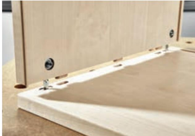
**Alles wie gewohnt:** Die Verbindungen werden mit der Dübelfräse DOMINO DF 500 verarbeitet. Die absaugbare Bohrschablone gibt die exakte Position des Bohrlochs sowie die korrekte Bohrtiefe vor.
