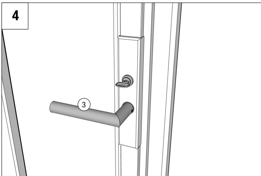
Der (3) Griff ist entriegelt und kann ebenfalls um 90° zur Bandseite abgeschwenkt werden.
