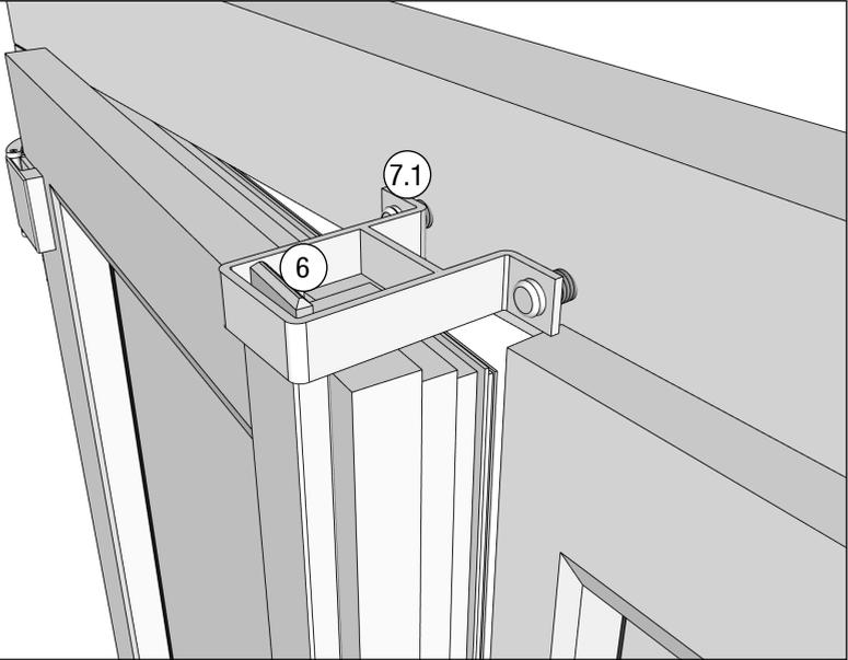
Grundeinheit nach Punkt 3 versperren, der (6) Riegelbolzen oben und unten ist nun starr in der zweiten Position vom (7.1) Kloben mit Spaltöffnung verankert.
