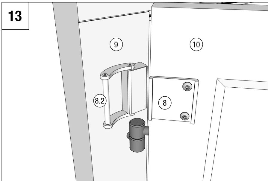
(10) Fensterflügel um 90° öffnen und (8.2) Verbindungsbügel von der (8) Bandsicherung in die Richtung vom (9) Fensterrahmen aufklappen.
