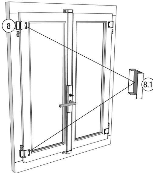
**Bandsicherungen auskoppeln** (8.1) Kunststoffabdeckung von (8) Bandsicherung flügelseitig entfernen.
