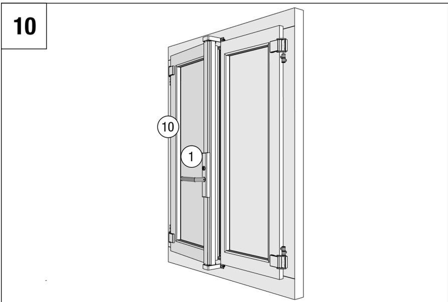
**Spaltöffnung bei Verwendung von BLASER Kloben mit Spaltöffnung** (1) Grundeinheit nach Punkt 2 - 5 entsperren und (10) Fensterflügel um ca. 5 cm öffnen.
