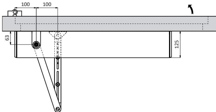
Wir empfehlen, einen bauseitigen Türanschlag zu montieren. Dieser begrenzt die Öffnungsbewegung des Türflügels und verhindert dessen Beschädigung im Handbetrieb. Optional kann der antriebs eigene Offenanschlag verwendet werden.
