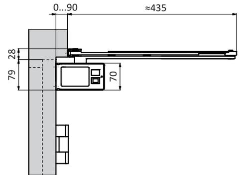
Wir empfehlen, einen bauseitigen Türanschlag zu montieren. Dieser begrenzt die Öffnungsbewegung des Türflügels und verhindert dessen Beschädigung im Handbetrieb. Optional kann der antriebs eigene Offenanschlag verwendet werden.
