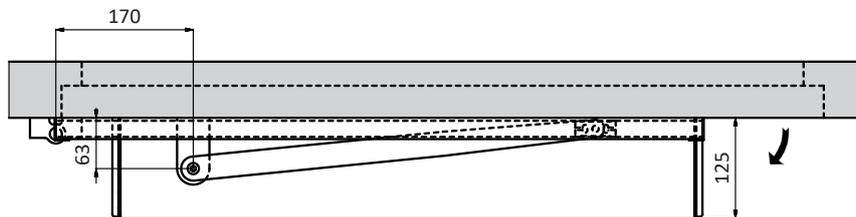
Wir empfehlen, einen bauseitigen Türanschlag zu montieren. Dieser begrenzt die Öffnungsbewegung des Türflügels und verhindert dessen Beschädigung im Handbetrieb. Optional kann der antriebs eigene Offenanschlag verwendet werden.
