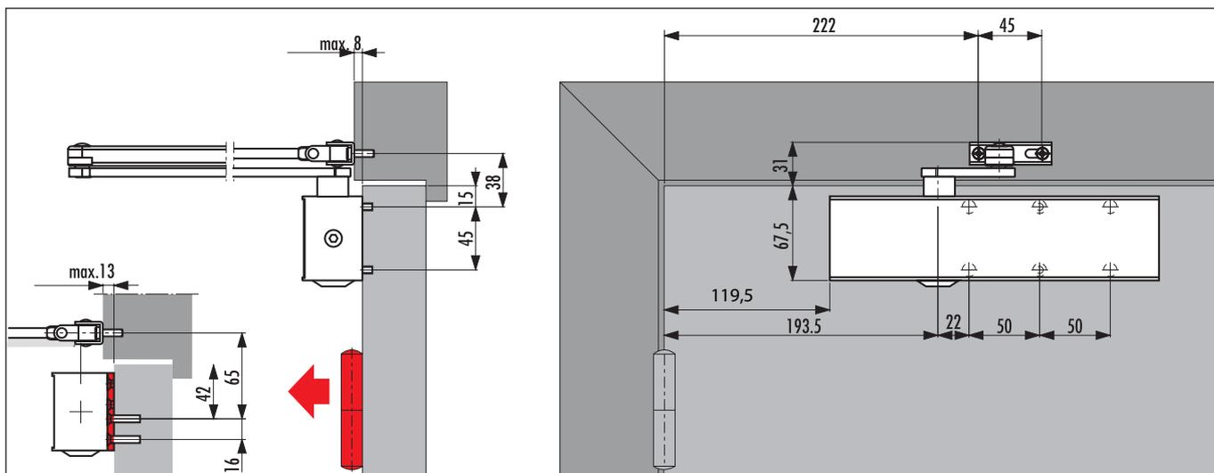
**TS 73 V Pose normale avec bras de blocage à crans d'arrêt**
