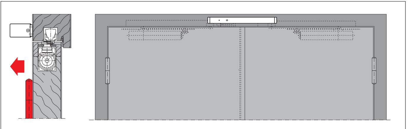
TS 96 centrale de détection de fumée RMZ-K/S côté opposé aux fiches en connexion avec ITS 96 GSR-EMF
