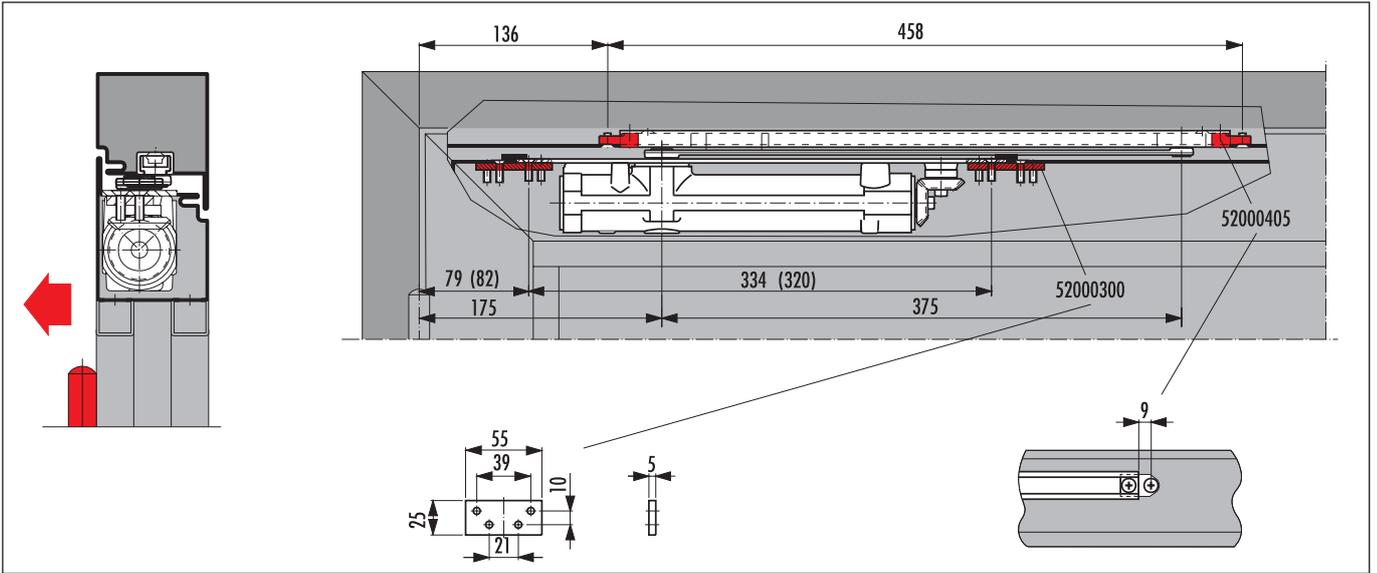
Éléments de fixation pour ajuster en hauteur G 96 N20, EMF, GSR
