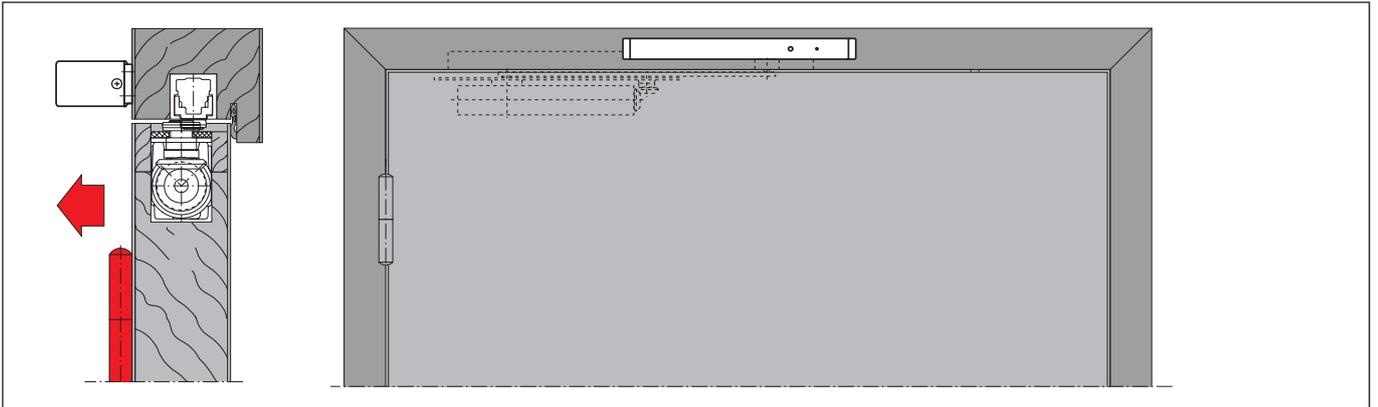
TS 96 centrale de détection de fumée RMZ-K/S côté fiches en connexion avec ITS 96 GSR-EMF
