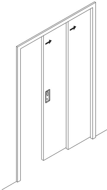
**Ferrure pour le coulisement simultané de 4 portes pesant jusqu'à 40 kg ou de 2-3 portes pesant jusqu'à 80 kg par vantail.**
