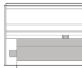
Obere Absenk-dichtung wird an der Stirnkappe oder dem Anlaufpfosten ausgelöst.
