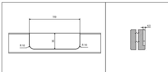
Effettuare la fresatura o manualmente con dima o con CNC.
