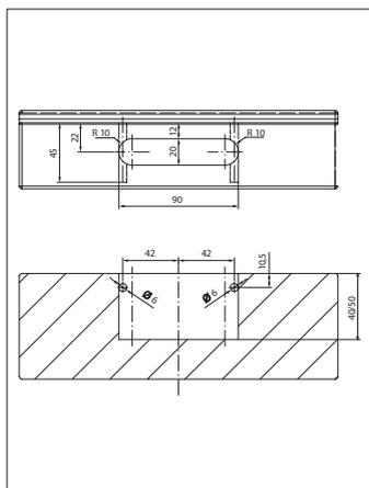
Effettuare la fresatura o manualmente con dima o con CNC.
