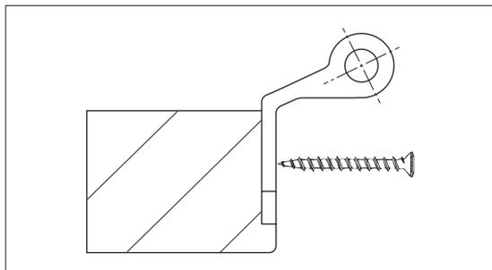
Montare l'anta sul telaio inserendo gli spinotti sia sopra che sotto e fissarli con le viti di sicurezza M6x6.
