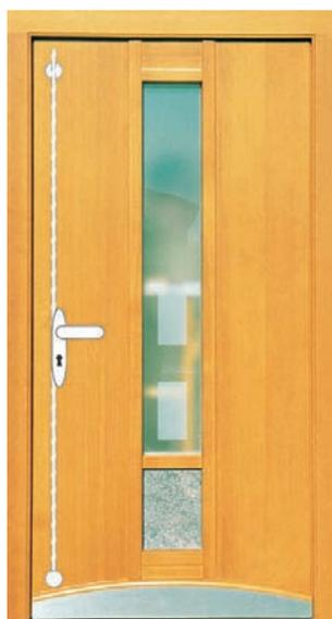
Mit dem völlig verdeckt eingebautem Beschlag ermöglicht man bei verzogenen Türen ein Ausrichten in beide Richtungen (durch Links- oder Rechtsdrehen mit dem mitgelieferten Inbusschlüssel 6 mm).
