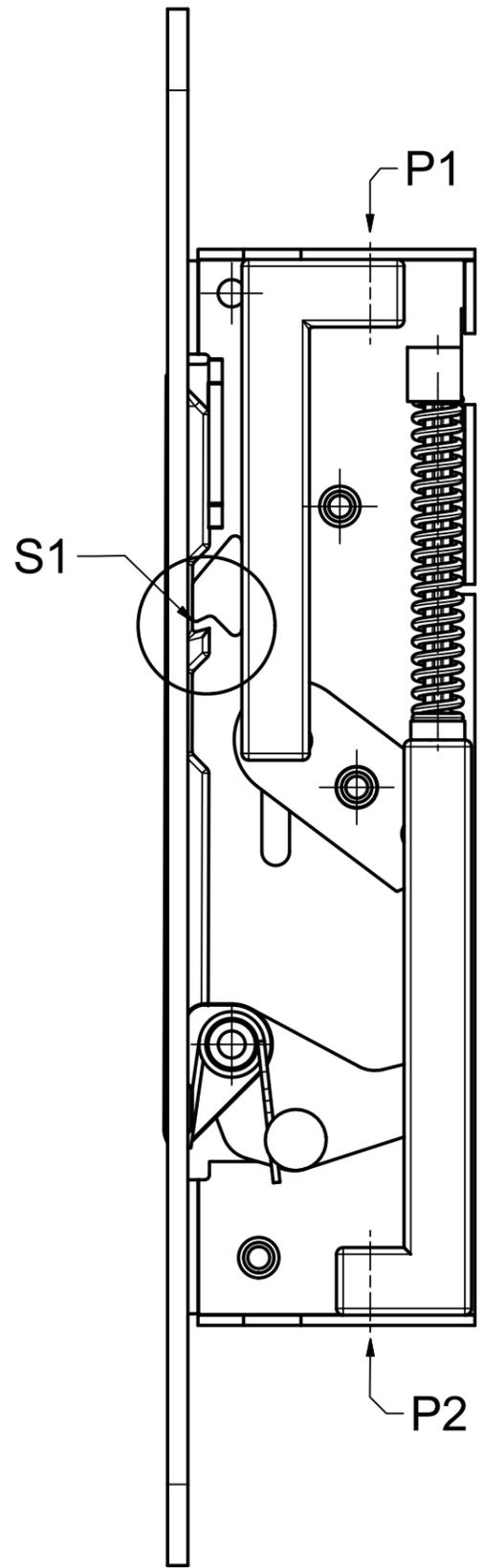
Sobald bei **P1** oder/und **P2** Druck ausgeübt wird, wird über den Schwalbenschwanz (**S1**) die Einbruchsicherheit gewährleistet
