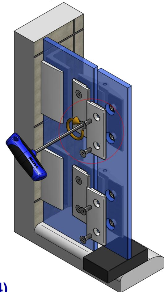
Die Zapfen des Beschlages mittig in den Glasbohrungen positionieren, um den größtmöglichen Verstellbereich für die Einstellung der Dusche zu gewährleisten. Um den späteren Abstand für die untere Dichtungslösung sicherzustellen, sollte der Türflügel mit Montageklötzen in der Höhe des beabsichtigten Abzugsmasses unterklotzt werden.
