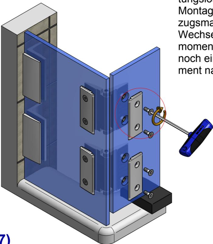
Die Zapfen des Beschlages mittig in den Glasbohrungen positionieren, um den größtmöglichen Verstellbereich für die Einstellung der Dusche zu gewährleisten. Um den späteren Abstand für die untere Dichtungslösung sicherzustellen, sollte der Türflügel mit Montageklötzen in der Höhe des beabsichtigten Abzugsmasses unterklotzt werden.
