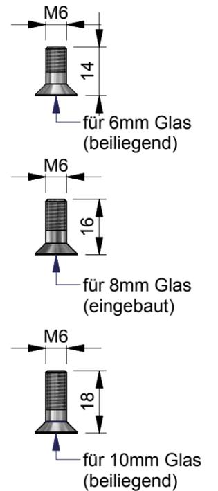
Wechselweise bis zum Erreichen des max. Anzugsmomentes von 10N·m anziehen.
