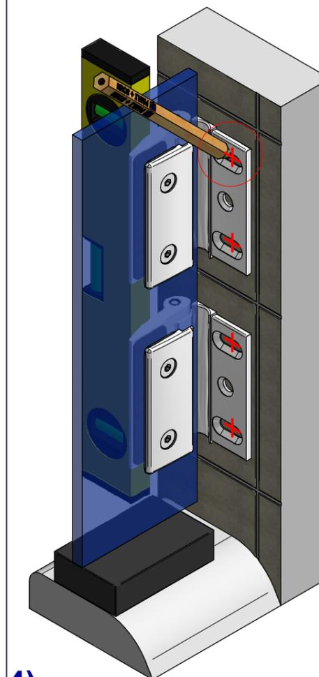
Aufsetzen des Türflügels auf den Wannens- bzw. Duschtassenrand mit den vormontierten Duschtürbändern um die Position der Bohrungen für die Wandlaschen anzuzeichnen. Um den späteren Abstand für die untere Dichtungslösung sicherzustellen, sollte der Türflügel mit Montageklötzen in der Höhe des beabsichtigten Abzugsmasses unterklotzt werden.
