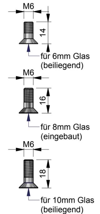
Wechselweise bis zum Erreichen des max. Anzugsmomentes von 10N·m anziehen.
