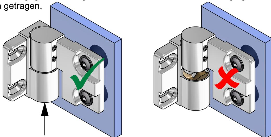
Die Befestigungsschrauben mittig in den Bohrungen positionieren, um den grösstmöglichen Verstellbereich für die Einstellung der Dusche zu gewährleisten. Benötigtes Werkzeug: Innensechskantschlüssel SW4mm
