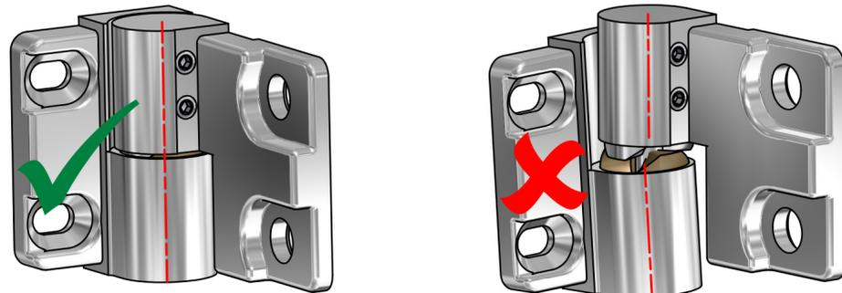
Beim Anzeichnen und bei der Montage an der Wand drücken Sie bitte immer bei beiden Bändern die Wandlasche gegen das Flügelteil hoch. Dadurch wird das Türflügelgewicht von beiden Bändern getragen.
