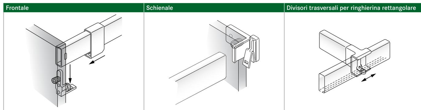
**FISSAGGIO DELLA RINGHIERINA CON REGOLAZIONE DELL'INCLINAZIONE DA AVVITARE**
