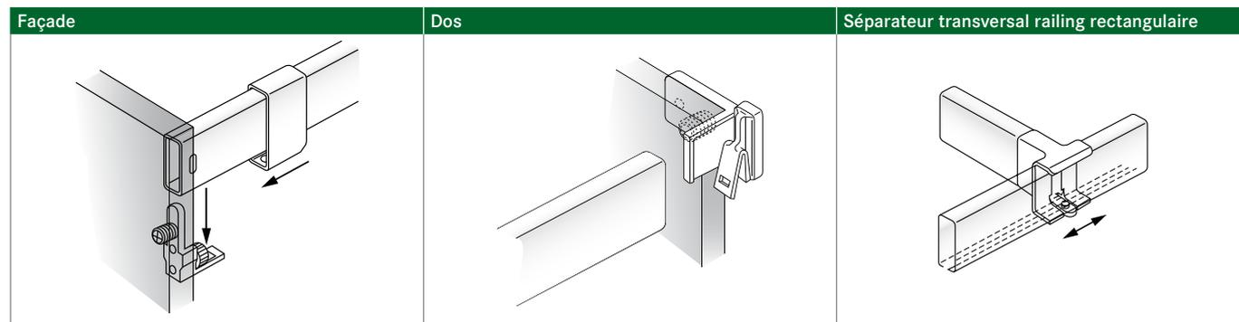
FIXATION DES RAILINGS AVEC RÉGLAGE DE L'INCLINAISON À VISSER
