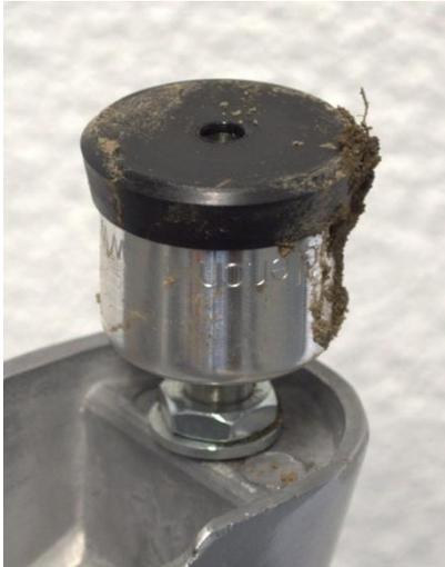
Verschmutzter NIVELER reinigen mit Seifenwasser. Bei starker Verschmutzung etwas Sprit benutzen
