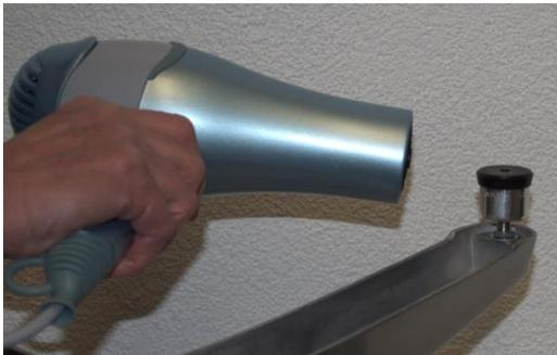
Kunststoffgleiter mit Föhn erwärmen, danach mit Zange entfernen.
