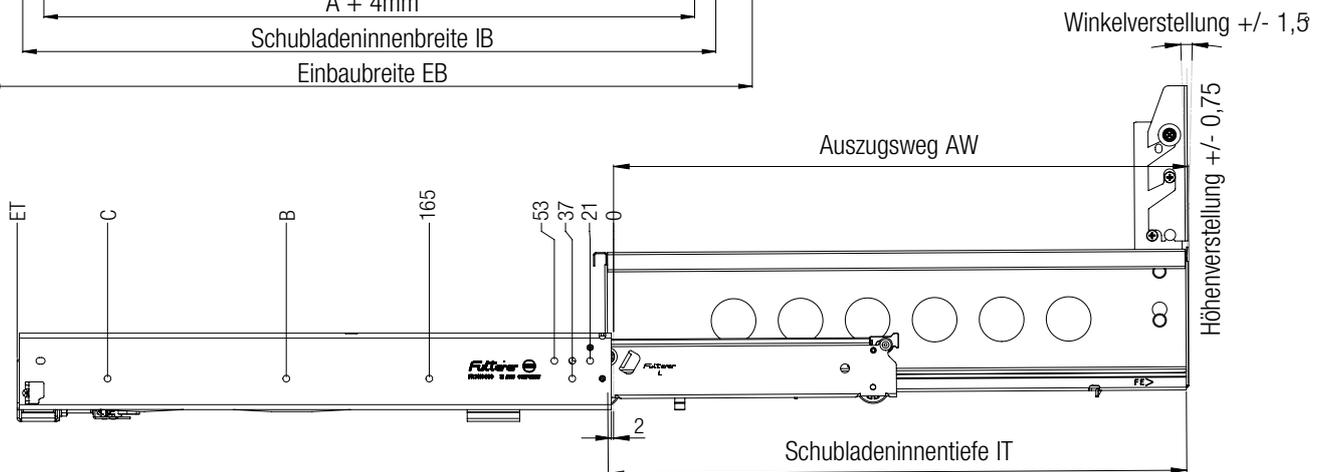
Anschraubbohrungen für 4,8 mm Senk-Blechschaube
