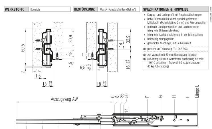
Anschraubbohrungen für 3,5 mm Spax-Schraube
