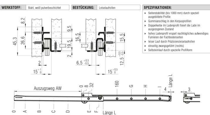
Anschraubbohrungen für 3,5 mm Spax-Schraube
