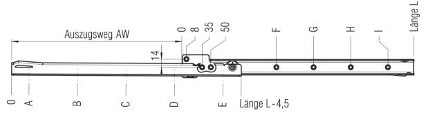
Anschraubbohrungen für 3,5 mm Spax-Schraube
