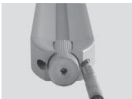
Verstellfuss am Aluprofil anschrauben
