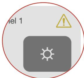
Sollte die Verbindung zum Wifi Emotion Gateway abbrechen, erscheint ein Symbol in der Fernbedienung. Bei einer fehlenden WLAN Verbindung erscheint ebenfalls das Symbol. Die App versucht sich automatisch wieder zu verbinden.
