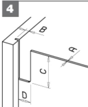
Presenza, spessore fodera (A), profondità della fresata (B) e dimensioni dello scasso (C, D).
