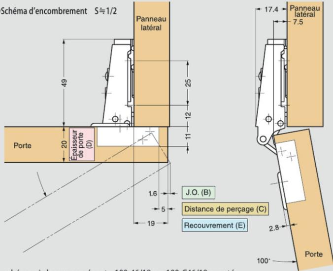
Le schéma ci-dessus représente 100-46/19 ou 100-C46/19 monté sur la plaque de montage 100-P3A : distance de perçage 5 mm, épaisseur de porte 20 mm et recouvrement 19 mm
