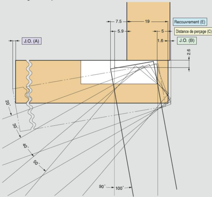
Schéma ci-dessus avec une distance de perçage de 8 mm, une épaisseur de porte de 20 mm, une épaisseur de panneau latéral de 20 mm et un recouvrement de 19 mm
