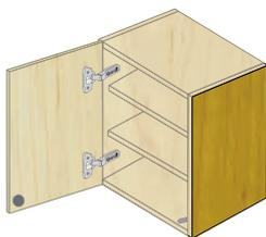
Diametro dell'alesaggio per magnete Ø 15 mm
