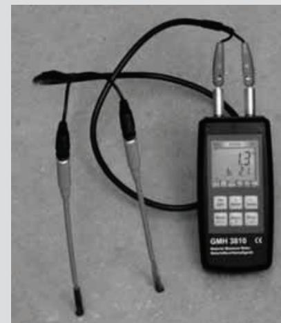
Mesure du béton avec sondes GBSL91
