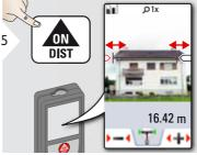
Selezionare le frecce con i tasti cursore o toccando il display e regolare con i softkey. Viene calcolata la larghezza.
