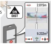
Selezionare le frecce con i tasti cursore o toccando il display e regolare con i softkey. Viene calcolata l'area.
