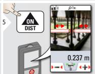
Selezionare le frecce con i tasti cursore o toccando il display e regolare con i softkey. Viene calcolato il diametro.
