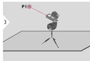
Definire un punto da misurare a una distanza superiore a 8 m. Mirare sul punto definito e premere il tasto DIST per avviare il conto alla rovescia di 5 secondi per la misura.
