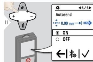
Scegliere se trasmettere il valore automaticamente o manualmente.
