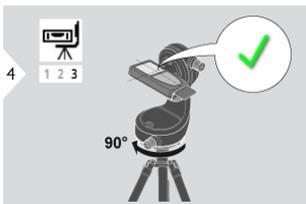
Ruotare il dispositivo in senso orario. Seguire le istruzioni sul display. Il livellamento è terminato quando sul display compare l'icona OK.
