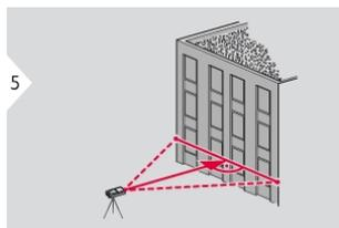
Puntare il laser sul secondo target.
