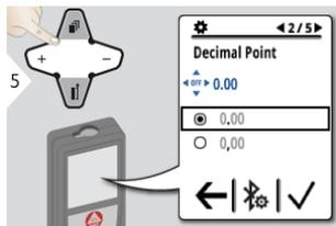
Selezionare il tipo di separatore decimale per il valore trasmesso.
