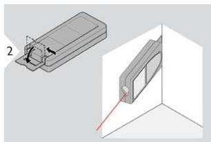
**i** L'orientamento dell'adattatore viene rilevato automaticamente e il punto zero viene impostato di conseguenza.
