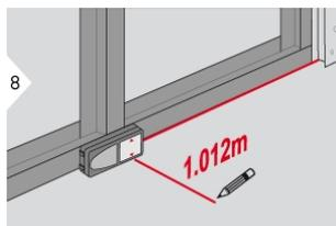
8 Spostare il dispositivo lentamente lungo la linea di tracciamento. Viene visualizzata la distanza dal punto di tracciamento successivo.
