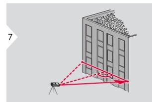
Puntare il laser sul terzo target.
