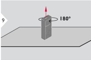
Ruotare il dispositivo di 180° in senso orizzontale e appoggiarlo nuovamente su una superficie perfettamente piana.
