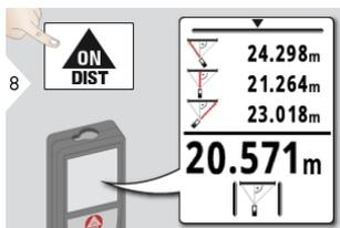
**i** Il risultato viene indicato nella riga principale e la distanza misurata sopra a questa. Premendo il tasto di misura per 2 s in questa funzione si attiva automaticamente la misura minima o massima. Si consiglia di usare la funzione Pitagora solo per la misura orizzontale indiretta. Per la misura dell'altezza (verticale) si ottiene una precisione maggiore con la funzione "Tracciamento altezza". Per acquisire i valori nella riga
