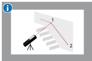
La distanza di raccordo viene calcolata in base a 2 coordinate note definite dai valori x, y e z.
