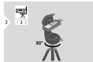
Ruotare il dispositivo in senso orario. Seguire le istruzioni sul display.
