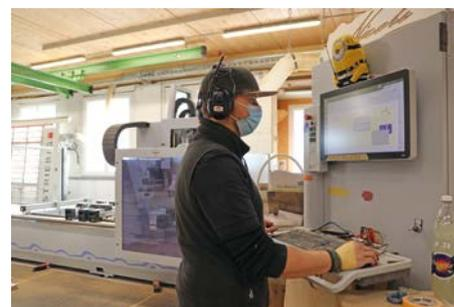
Die CNC-Maschine wird direkt mit den Konstruktionsdaten aus dem CAD programmiert
