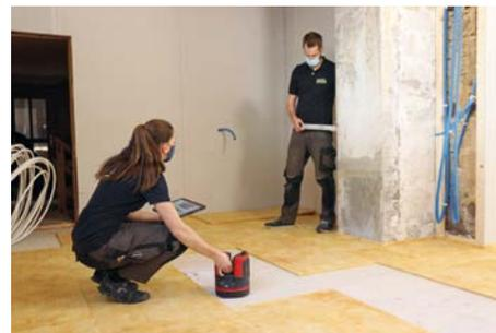
Messen von verdeckten Punkten mit dem Leica 3D Disto und einem speziellen Lineal
