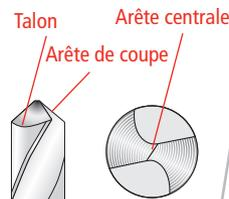
Toute la surface s'étendant de l'arête de coupe jusqu'au talon doit présenter une surface finement meulée sans stries ni empreintes. Le talon est toujours moins élevé que l'arête de coupe. L'arête centrale sera propre et droite.
