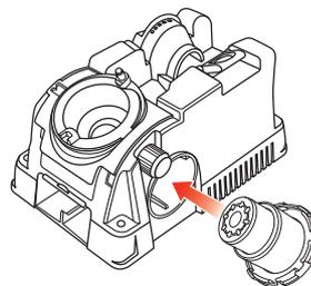
Le tube d'évacuation de la limaille est conçu de manière à ce que les étincelles produites par l'affûtage restent dans la machine, loin de vous. De plus, le tube d'évacuation de la limaille réduit la quantité de poussière dans l'air et sur votre établi.
