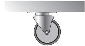
I carichi specificati nel catalogo sono valori statici (il dispositivo di trasporto non si muove) validi per pavimenti lisci, piani e puliti. In presenza di un carico dinamico sino a max. 4 km/h, è necessario sottrarre sino al 50% del carico delle rotelle (a seconda delle caratteristiche del pavimento).
