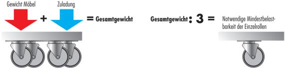
Die im Katalog angegebenen Belastungen sind statische Werte (das Transportgerät bewegt sich nicht) auf glatten, ebenen und sauberen Böden. Bei dynamischer Last bis max. 4 km/h müssen je nach Bodenbeschaffenheit bis zu 50% der Rollenbelastbarkeit abgezogen werden.
